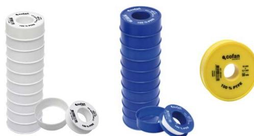
Esta cinta de PTFE se utiliza principalmente como elemento de sellado. Resistente a los productos químicos y disolventes conocidos, a excepción del Flúor gaseoso a alta temperatura, Tri-fluoro Cloro, metales alcalinos fundidos o en solución. Puede ser utilizado en un rango de temperatura: -200°C a 260°C; tiene un coeficiente bajo de fricción, es insípido, insoluble e inodoro. Las cintas están normalmente disponibles en carretes de plástico.
